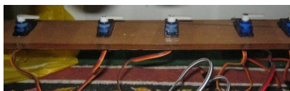
Gambar 3. Motor servo sebagai output dari Alat kontrol Angklung
